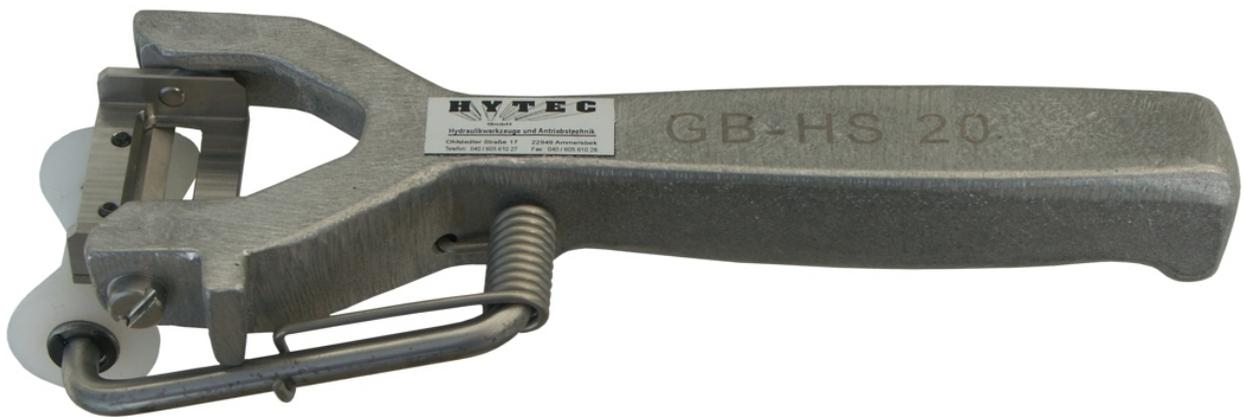
Zum Längsschälen der extrudierten Halbleiterschicht
